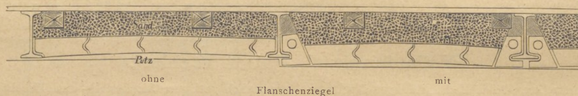
Längenschnitt des Patentgewölbes bei einer Zimmerdecke
