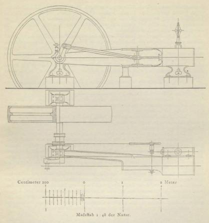
stange aufnahm. Dieser Zapfen, 65 Millimeter lang, 45 Millimeter dick, arbeitet mit 122 Kilogramm per Quadrateentimeter Schalendruck, nachdem sich der gesammte Dampsdruck auf den Kolben (3650 Kilogramm) aus seiner Fläche von
