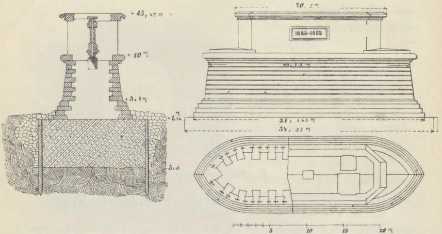
von 14 Meter Breite und 34,95 Meter Länge, welches Betonfundament durch einen Steinwurf geschützt ist.
