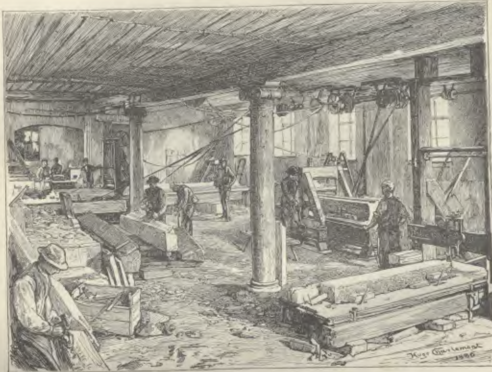
Steinhobel in der Marmorwaarenfabrik in Oberalm bei Hallein.
